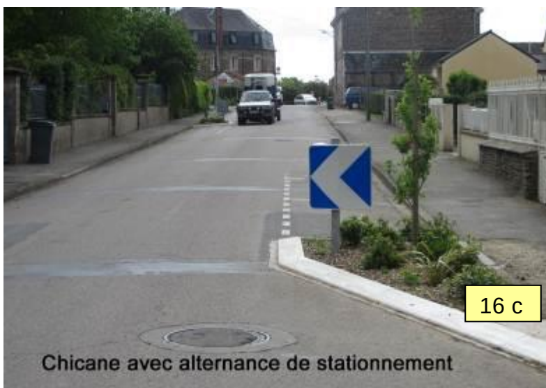
Chicane par avancées de trottoir
