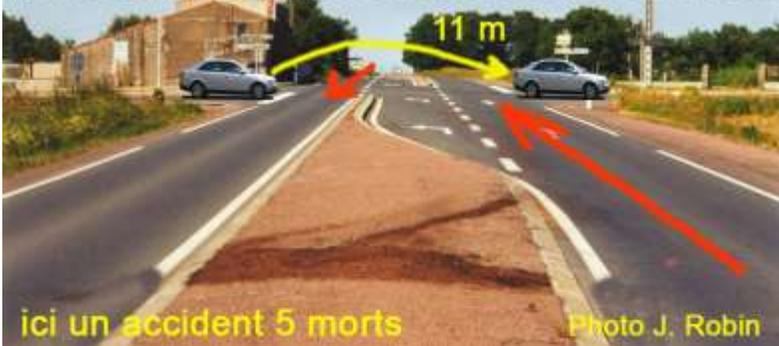
Ce type de carrefour est pourvoyeur d'accidents GRAVES, il a été mis au point dans les années 1960, à une époque où la vitesse était considérée comme une vertu, une valeur, il permet aux voitures et aux motos allant tout droit de le franchir sans se soucier des véhicules qui traversent : il ne faut pas leur "couper la route".
