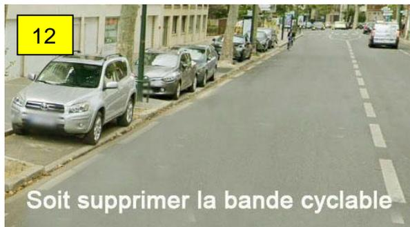
**Solution de suppression de la bande cyclable** : du point de vue de la sécurité, il est préférable de ne pas avoir de bande cyclable plutôt qu'une bande cyclable dangereuse car trop étroite et ne permettant pas de s'éloigner des voitures en stationnement comme le décret du 2 juillet 2015 le leur permet. Dans ce cas, le code de la route s'applique tout simplement : le conducteur qui dépasse un cycliste doit laisser un écart de 1 mètre (en aggro).
