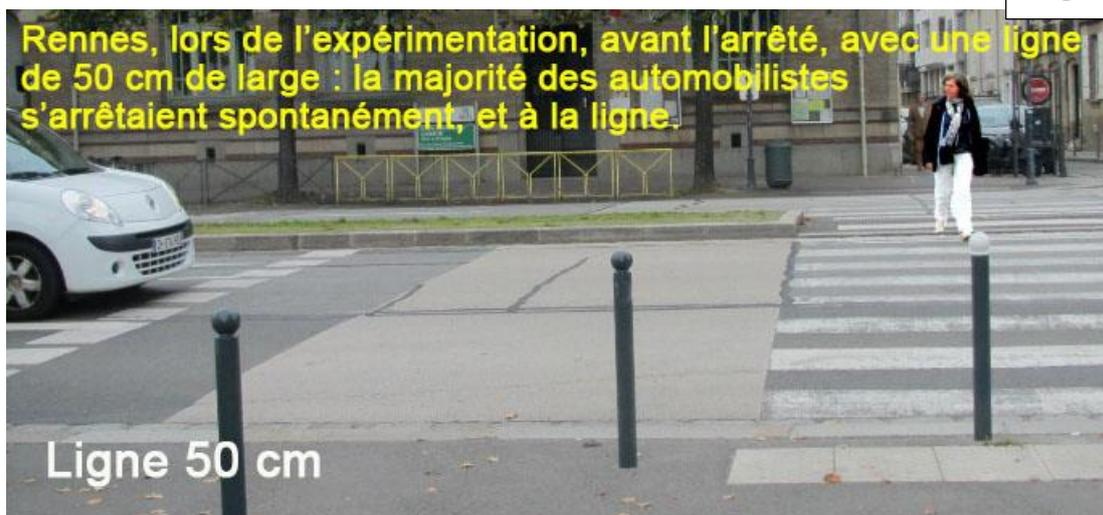
**2<sup>ème</sup> insuffisance sécuritaire : l'arrêt vraiment à la ligne.** D'autre part parmi ceux qui les laisseront traverser, une trop faible partie s'arrêteront à cette ligne de 15 cm et ils s'approcheront trop près du passage piéton, diminuant ainsi la visibilité des piétons qui traversent.
