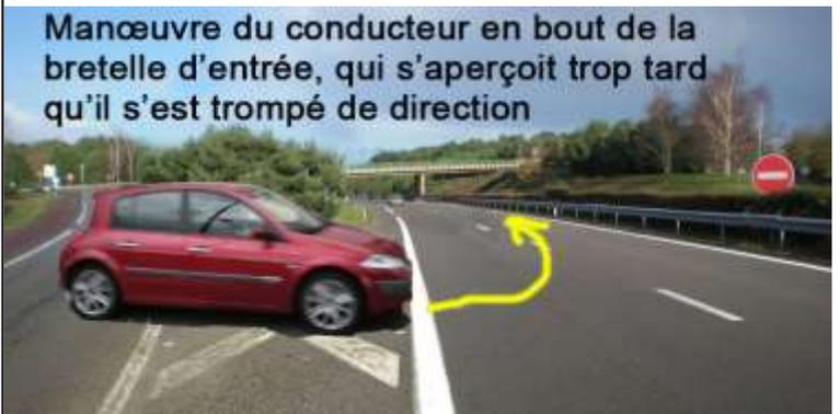
Pour éviter ceci, placer 2 panneaux sens interdits b1 et b2 assez loin, et flèches blanches au sol
