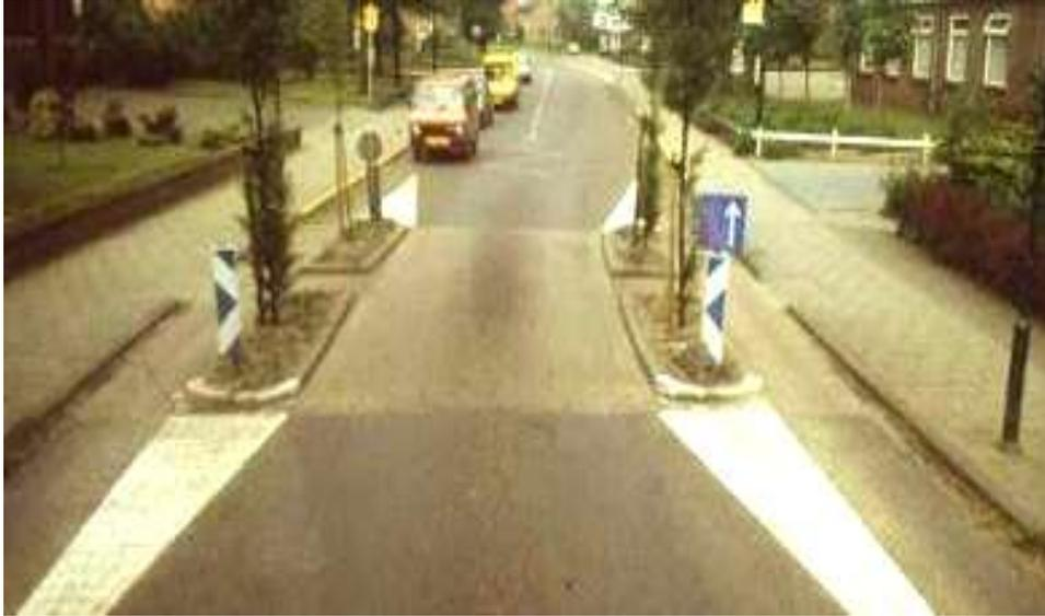
**L'écluse simple LATÉRALE** est réalisable même dans le cas d'une chaussée étroite et que l'on ne dispose pas de beaucoup de largeur : c'est en fait une avancée de trottoir d'un côté. Le ralentissement est plus fort dans le sens qui circule sur le côté de l'avancée de trottoir et peu important dans l'autre sens du fait qu'il ne subit pas de déflexion de trajectoire.
