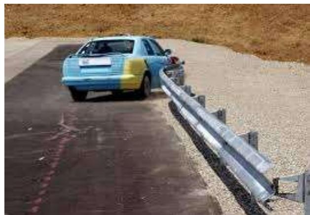
**4 - Fonctionnement d'une glissière (suite).** La lice de la glissière doit donc être à plus de 1,50 m du bord de chaussée. La lice est séparée du support par un écarteur. Au moment du choc le support s'incline, ce qui nécessite en plus de disposer de 50 cm à 1 m derrière la glissière, selon le type de glissière. L'éloignement nécessaire total entre la chaussée et l'arbre est donc de 2,50 m.
