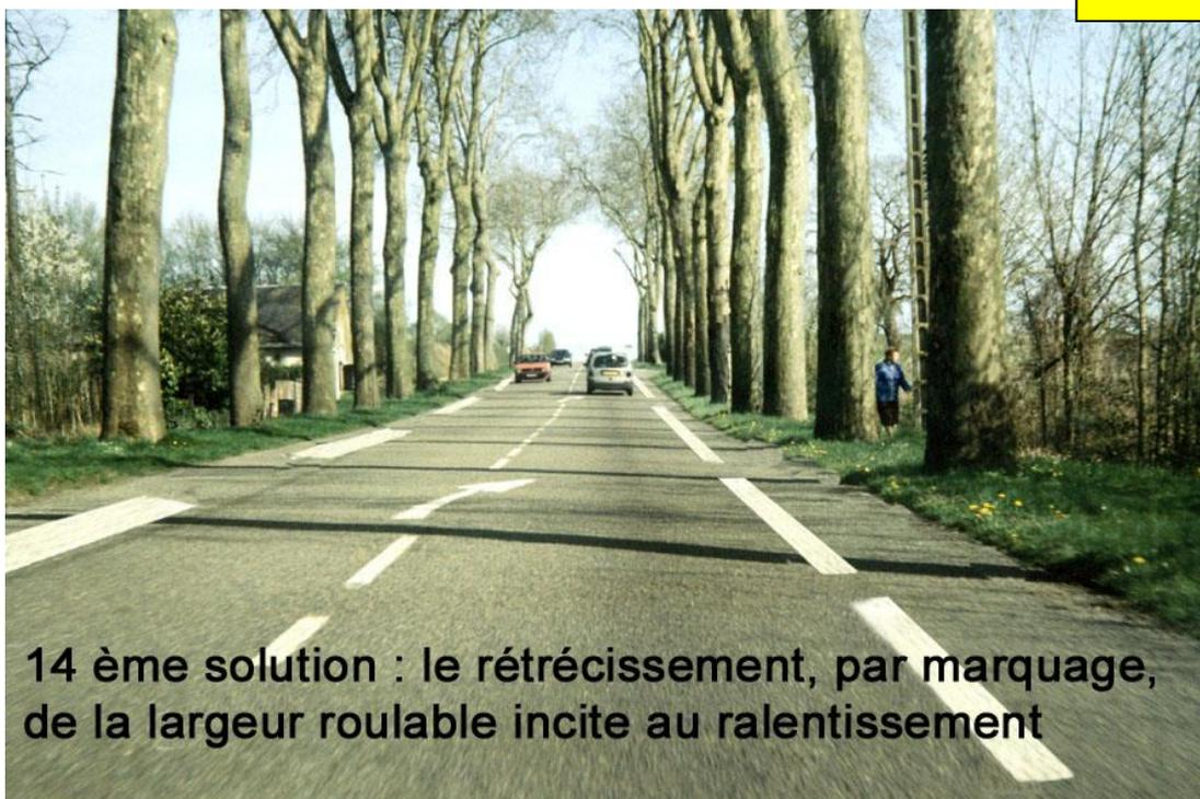
**14<sup>ème</sup> solution : le rétrécissement, par marquage, de la largeur roulable incite au ralentissement**
