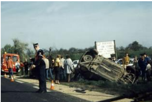
sans arbre : un tonneau 2 blessés légers un occupant ceinturé faisant un tonneau subit une décélération faible.
