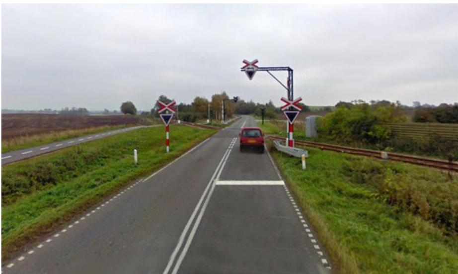
Exemple de bande d'arrêt blanche devant un passage à niveau au **Danemark**
