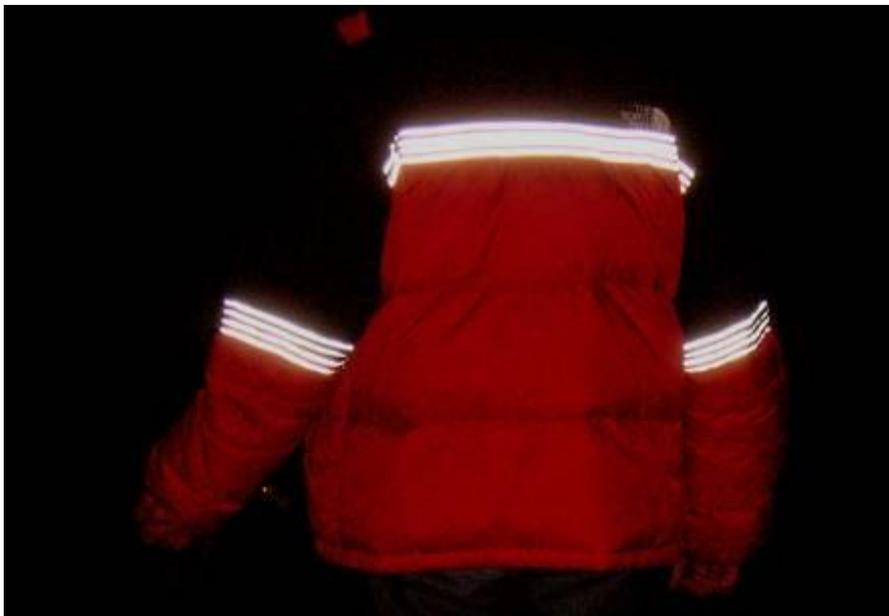
Le même anorak vu dans les phares la nuit - deux largeurs de rubans rétro réfléchissants On voit nettement sur cette photo et la suivante, que la lumière réfléchi par les deux petits filets irradie très largement pour donner une large plage lumineuse.
