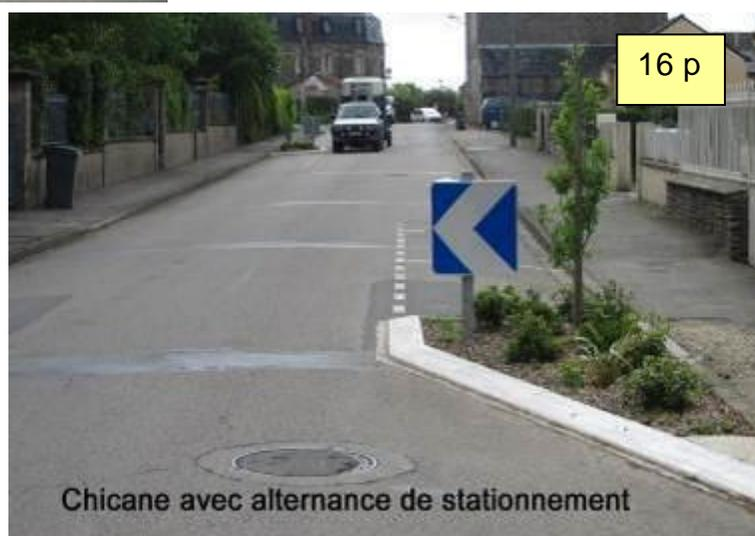
Sur la photo à droite les voitures stationnées sont protégées par un îlot. Si l'on ne met pas de tels îlots (photo ci-dessus) les automobilistes craignent d'y stationner leur voiture et de ce fait ils stationnent en empiétant sur le trottoir.
