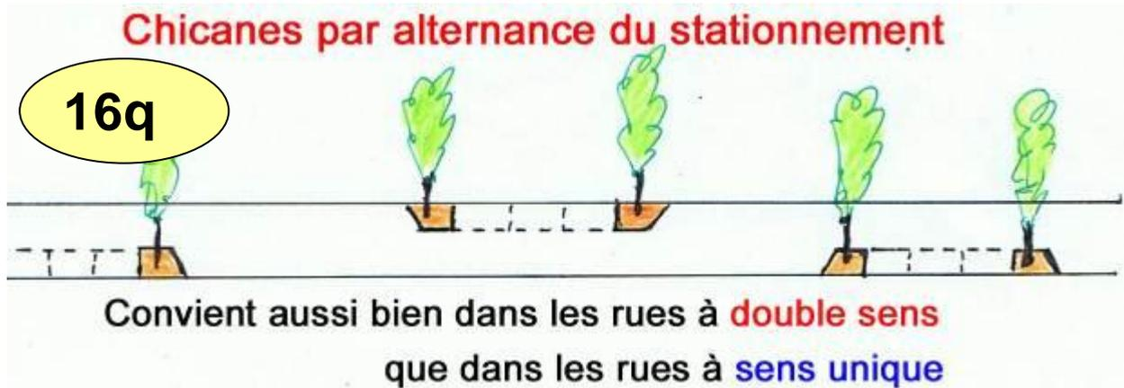
C'est une solution élégante du point de vue esthétique et qui n'est pas onéreuse : des bordures de trottoir à poser et des trous à creuser à la pelle mécanique pour mettre les arbres.
