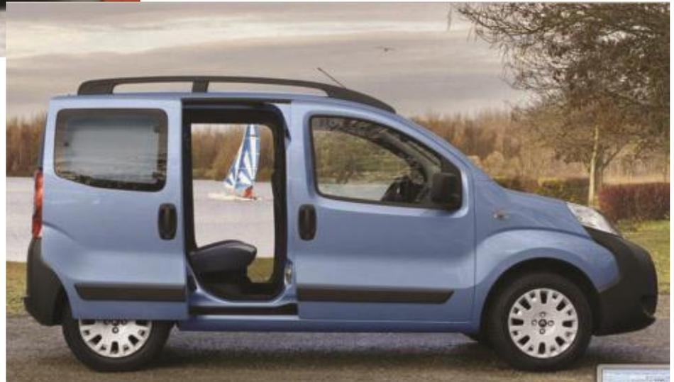
**2<sup>ème</sup> solution** pour limiter les dangers pour les cyclistes des portes qui s'ouvrent : placer les charnières des portes à l'arrière.
