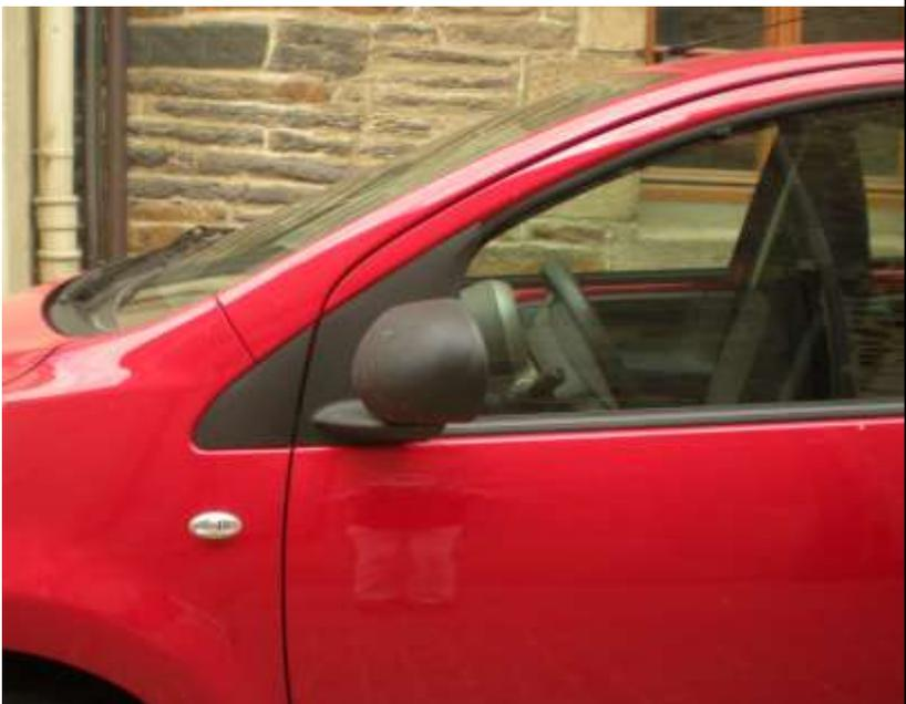
Le pare-brise plongeant réduit la gravité des blessures du piéton en cas de choc, mais un montant large, est nocives sur le plan visibilité : on risque plus de ne pas voir le piéton car le montant du pare-brise plongeant est loin des yeux du conducteur, donc rétrécit l'angle de visibilité. **Le montant est large et très masquant car il cumule quatre fonctions** :
