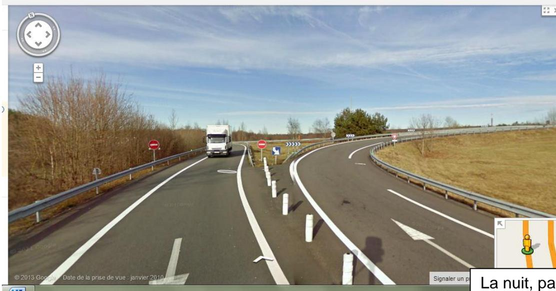
La nuit, par brouillard, les panneaux derrière les glissières ne se voient pas bien
