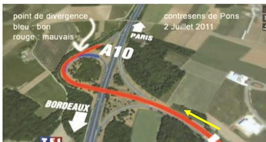
Pour une raison quelconque, l'automobiliste entré au péage s'est positionné sur la voie de gauche en passant à travers les balisettes (là n'est pas le problème), et s'est retrouvé au point de divergence sur la flèche rouge et quand un automobiliste est persuadé d'avoir bien suivi la signalisation directionnelle, ce n'est pas 2 panneaux B1, assez discrets, qui lui corrigeront son erreur. Au point de divergence il y a une absence totale de signalisation directionnelle qui pourrait le renseigner.
