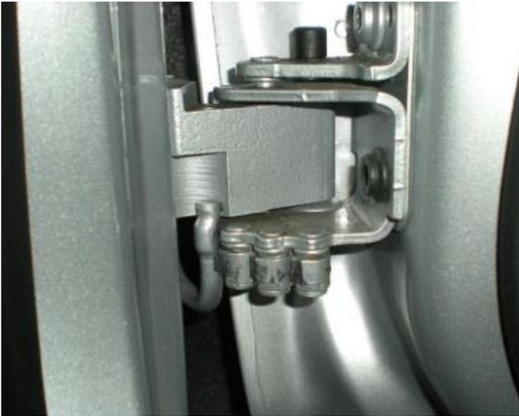
Ces crans rendent l'ouverture de la portière plus sécurisante car la portière ne se trouve pas « lancée » brutalement sur toute sa largeur : le 1<sup>er</sup> cran permet de s'arrêter dans un premier temps à une ouverture de 25 cm, Là, le cycliste a le temps de réagir, et le conducteur a la possibilité de regarder vers l'arrière.
