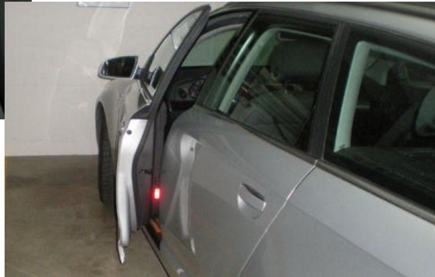
Une charnière solidement crantée permet au conducteur d'ouvrir la portière par arrêts successifs, donc de mieux contrôler sa vitesse d'ouverture et d'éviter qu'elle soit ouverte brutalement sur toute sa largeur,
