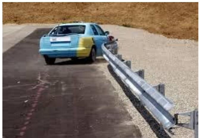
À la suite de ce glissement sur quelques mètres, la majeure partie de l'énergie du véhicule a été absorbée et le véhicule est redirigé avec une faible vitesse résiduelle, parallèlement à la glissière.
