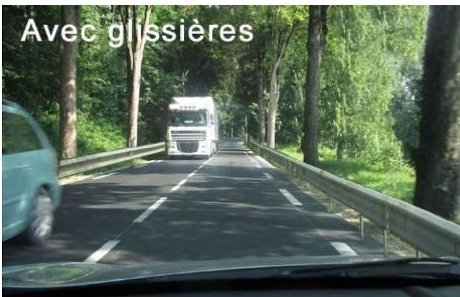
La solution "glissières" pour des arbres si proches, serait **dangereuse** car à la moindre déviation vers la droite (de la voiture d'où est prise la photo) la glissière renverrait sèchement la voiture vers le camion en collision frontale.
