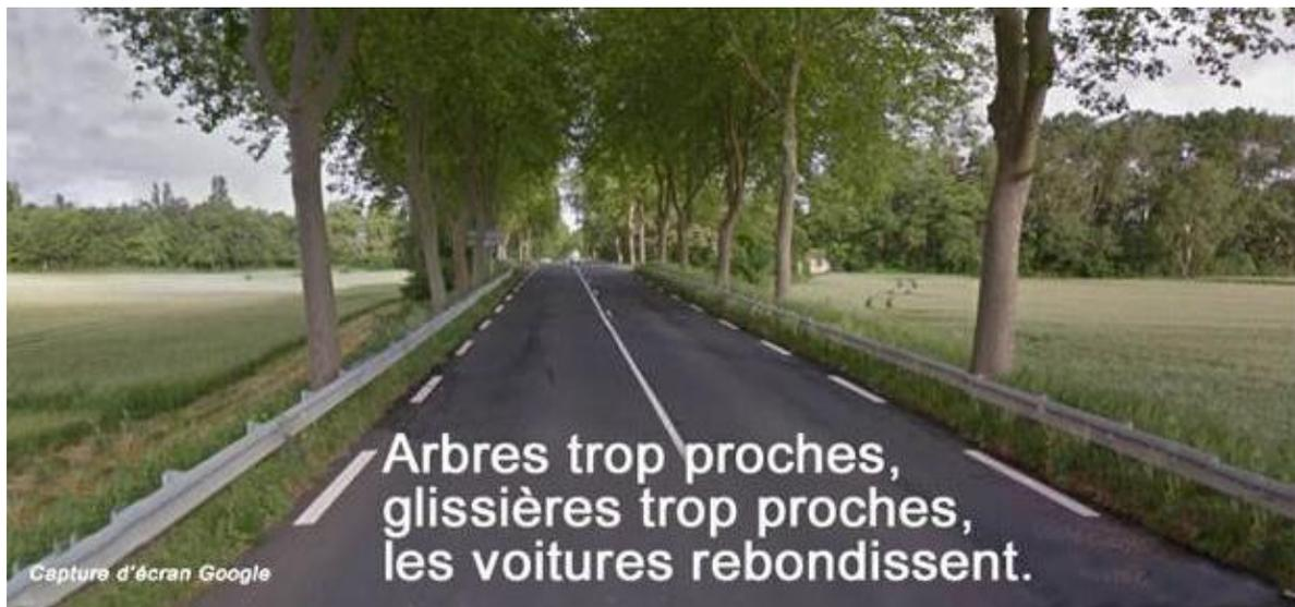
En conclusion, si la glissière est posée devant des arbres trop proches (moins de 2,50 m), la vitesse doit être limitée à 60 km/h du fait du risque de collision frontale.
